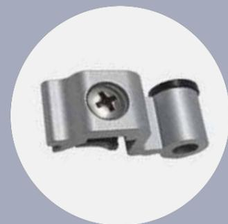
Blocchetto anti sfilamento. Evita lo sganciamento accidentale dell'anta dal telaio. Accessorio di serie su tutte le persiane con telaio e cerniere standard.
